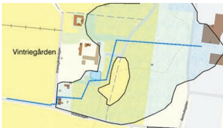
Karta över däckningsföretag för Vintriegården med flera. Båtnadsområdet är inringat med svart linje. Dräneringsledningen visas med blå linje. Källa: Jordbruksverket.
