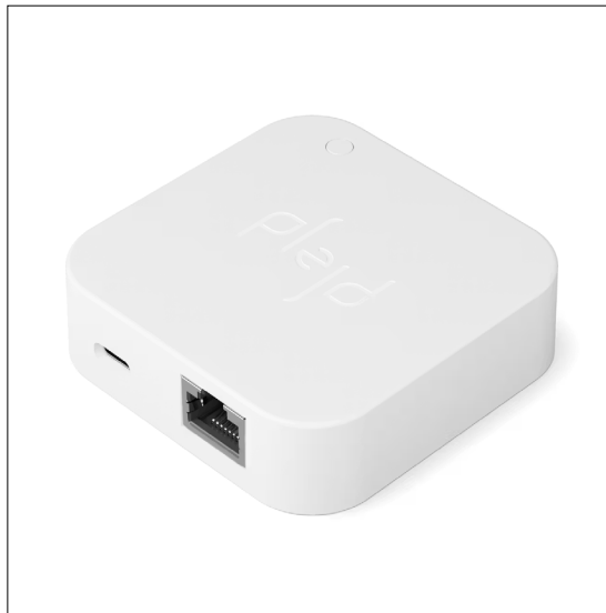
Plejd-gateway. (att kunna styra utanför hemmet)1/hus
