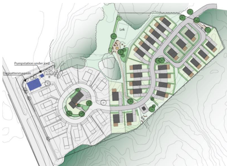
Illustration som visar dagvattenmagasinets och den underjordiska pumpstationens placering inom småhusområdet Murarbo.
