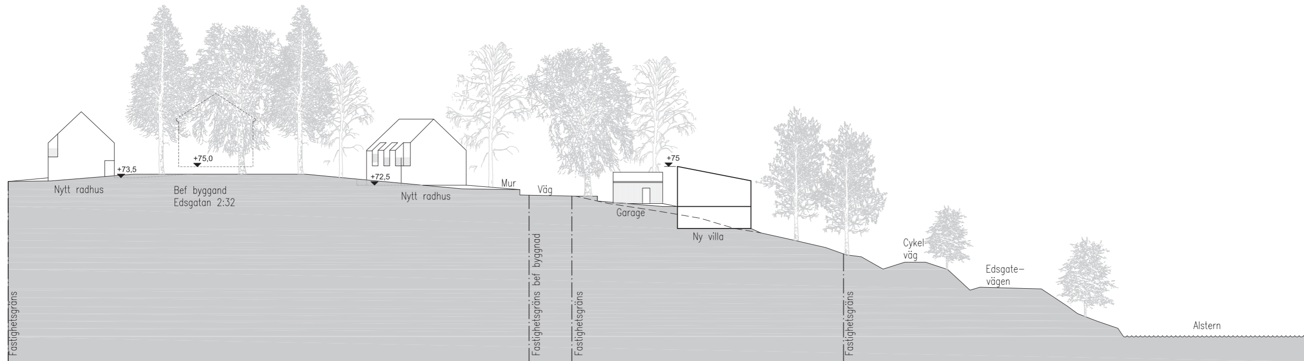
SEKTION A-A FRÅN VÄSTER TILL ÖSTER GENOM RADHUS I NORR VIA ILLUSTRERAT MANGÅRDSDHUS (BEF BYGGNAD) TILL VILLA TYP I I SLUTTNING NER MOT G:A BANVALLEN (CYKELVÄG)
