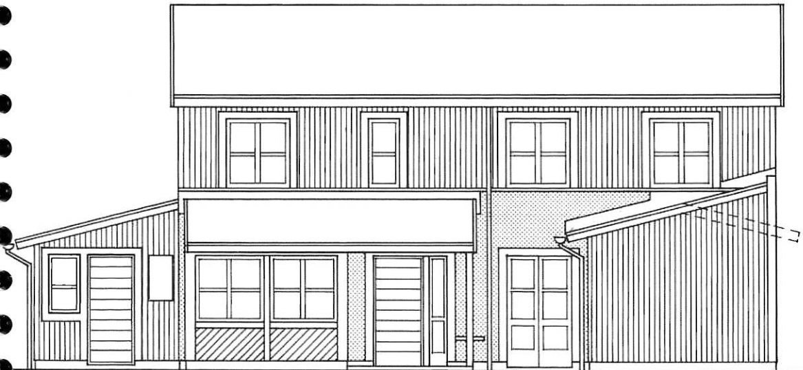
FASAD MOT ENTRÉGÅRD (ALT. PUTS O. PANEL) Hustyp B5 har sadeltak på sidobyggnaden
