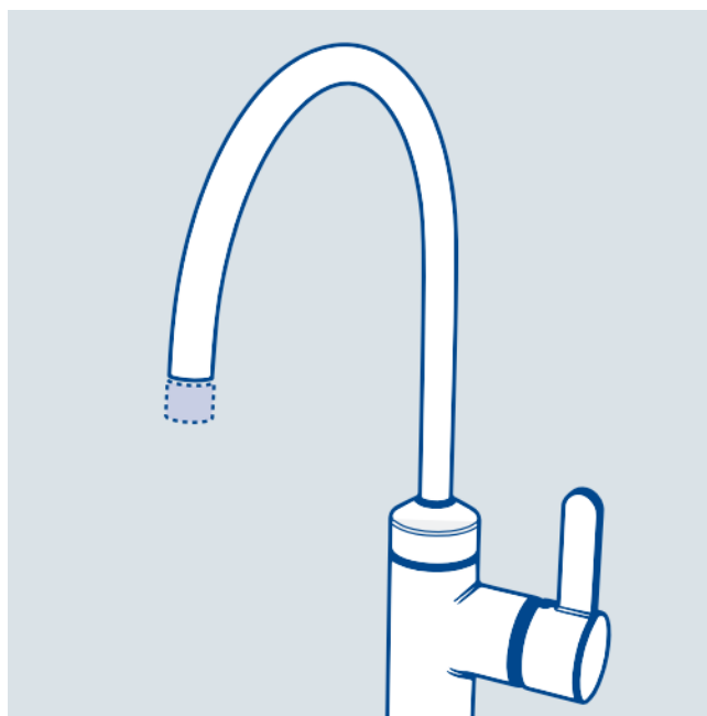
Ett sätt att minska vattenförbrukningen är att byta ut det gamla munstycket till ett vattenbesparande munstycke.
