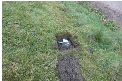
Bild 4. Triggare, före jordtäckning
