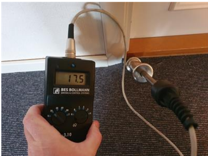
Fuktmätning vid golv/väggvinkel
