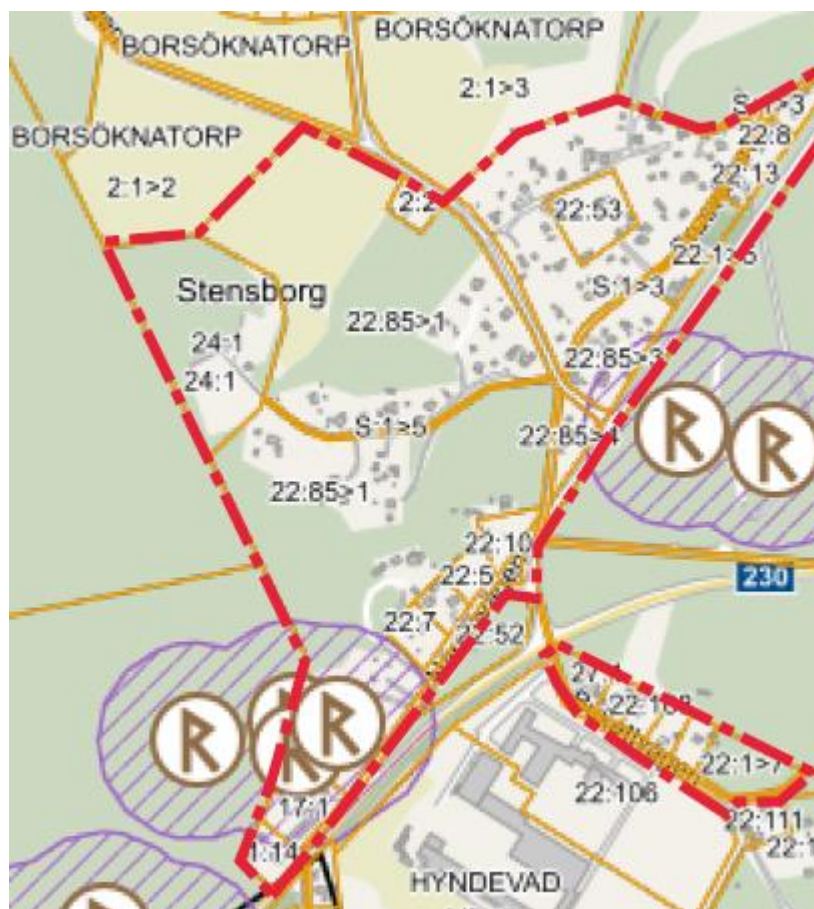
Kartans bruna runmarkeringar visar formlämnin/fornlämningar inom detaljplaneområdet och de skrafferade ljuslila linjerna visar zoner med 100 meters radie runt dessa. Röd streckprickad linje visar plangräns. © Eskilstuna kommun Lantmäteriet Riksantikvarieämbetet
