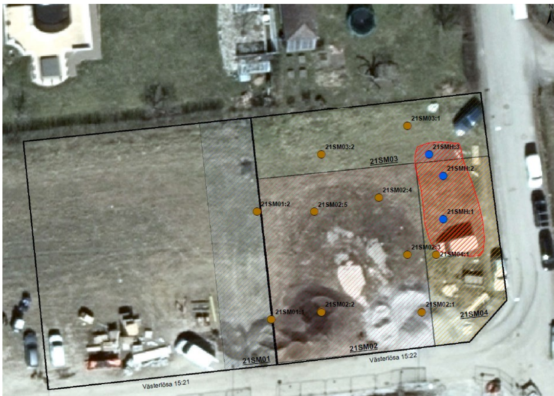
Figur 3. Inmätta provtagningspunkter från undersökningen med egenskapsområden/delområden skrafferade i olika färger. Högen som provtogs är markerad med rödskrafferat område och blå provpunkter.
