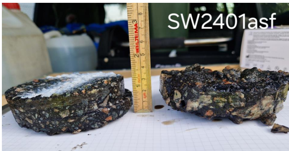
Figur 3. Borrhuck från provpunkt SW2401asf delad, där övre delen av pucken ligger till vänster i bild och undre pucken, som luktade starkt, ligger till höger i bild.
