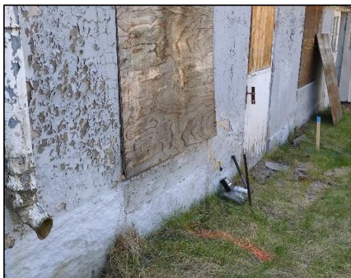
Figur 7. Foto ovan till vänster visar mätning av porluft i provpunkt P2 och fotot ovan till höger visar mätning i provpunkt P3, inne i byggnaden.
