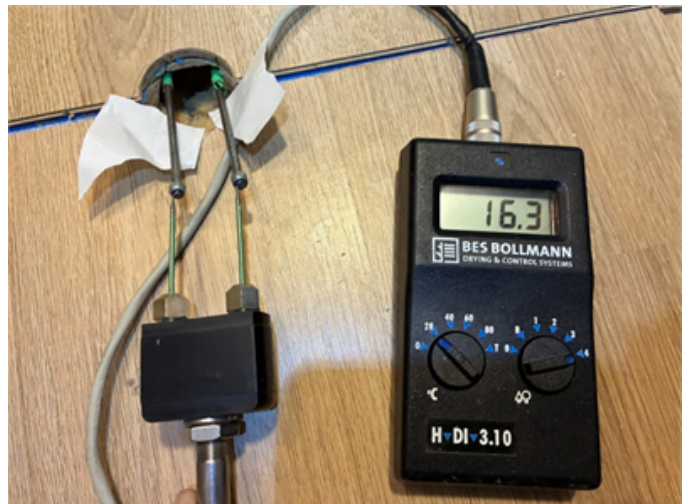
Bilden visar fuktkvotsmätning i golvkonstruktion i sovutrymme. Gränsvärde är 17%.
