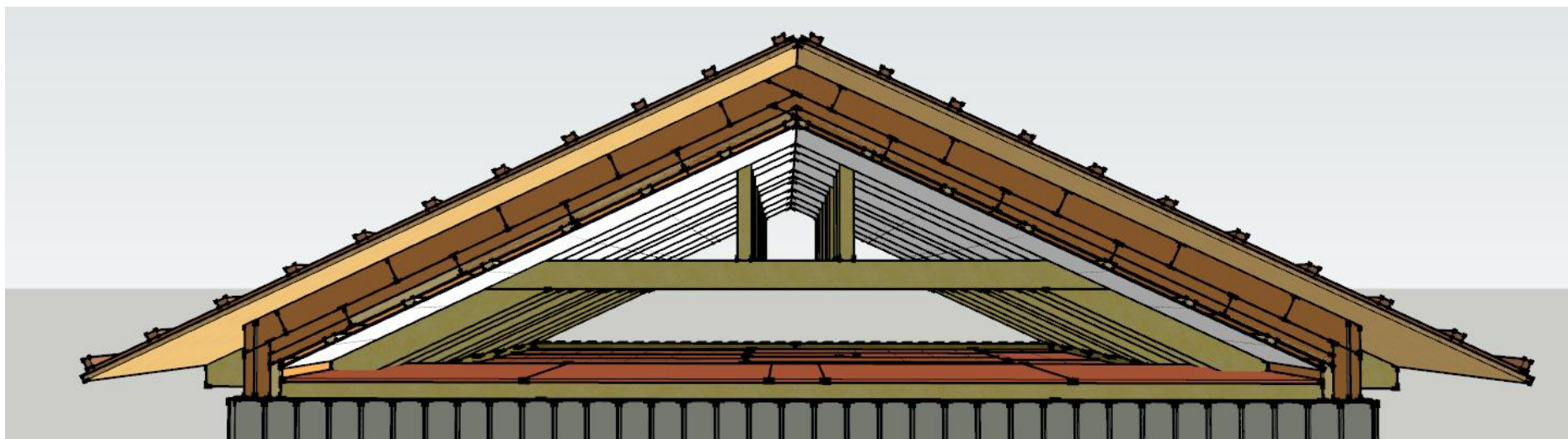
Tvärnitt tak/loft. Isolering lagt om lott 120+95 mm stenull. För att skära tillnocken/takfoten bra tillverkades en jigg med rätt vinkel. Tryckimpregnerade strö/bärläkt.
