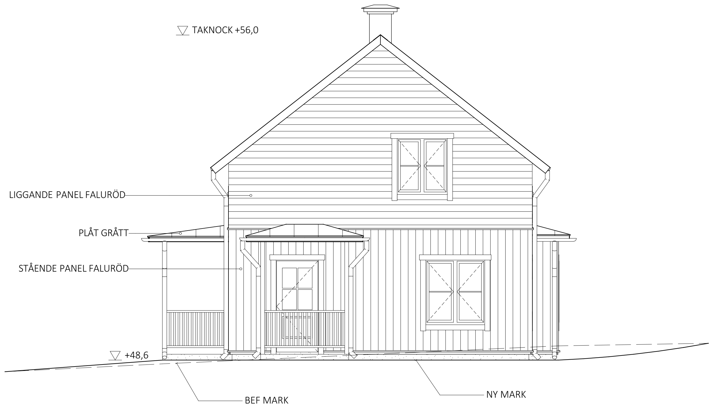
FASAD MOT NORDÖST
