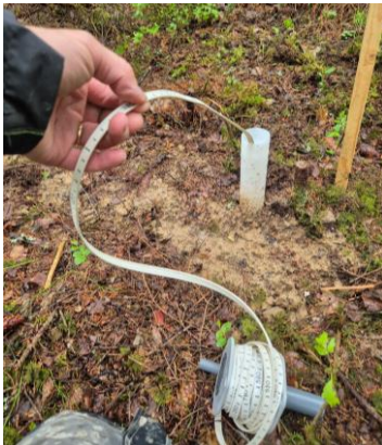
Bild 2.1.1: Bilden visar nedmätning i grundvattenrör.
