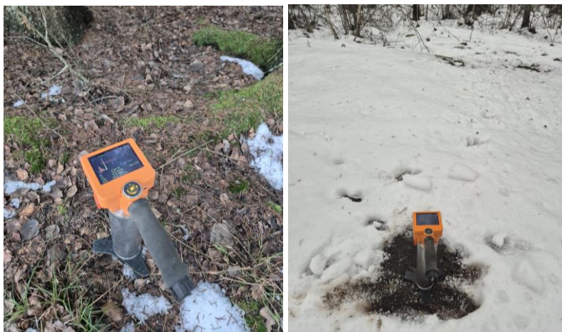
Bild 5.1.1 – 5.1.2: Bilderna visar två av de utförda borrhöjningarna, på lera i punkt 111 och mot berg i punkt 117.
