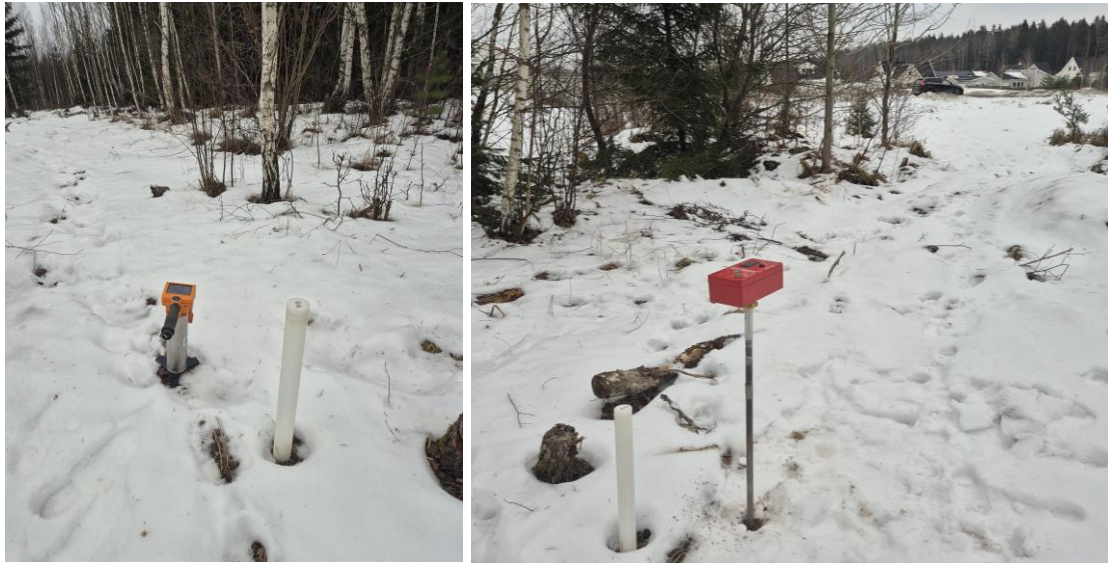
Bild 5.1 och 5.2: Bilderna visar radongasmätningssutrustningen Markus 10 och gammaspektrometer vid mätning mot naturligt lagrad sand på torr lera på morän i borrhunkt 107.
