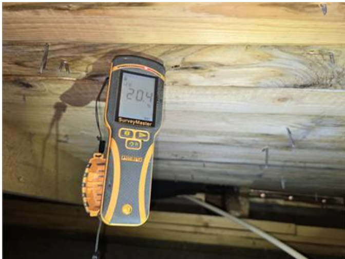
Nockvind: Fuktanvisning i underlagtak med förhöjda fuktvärden.
